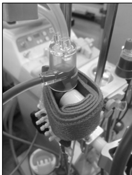
Fig.1 静脈側エアトラップチャンバへの加速度センサの装着
