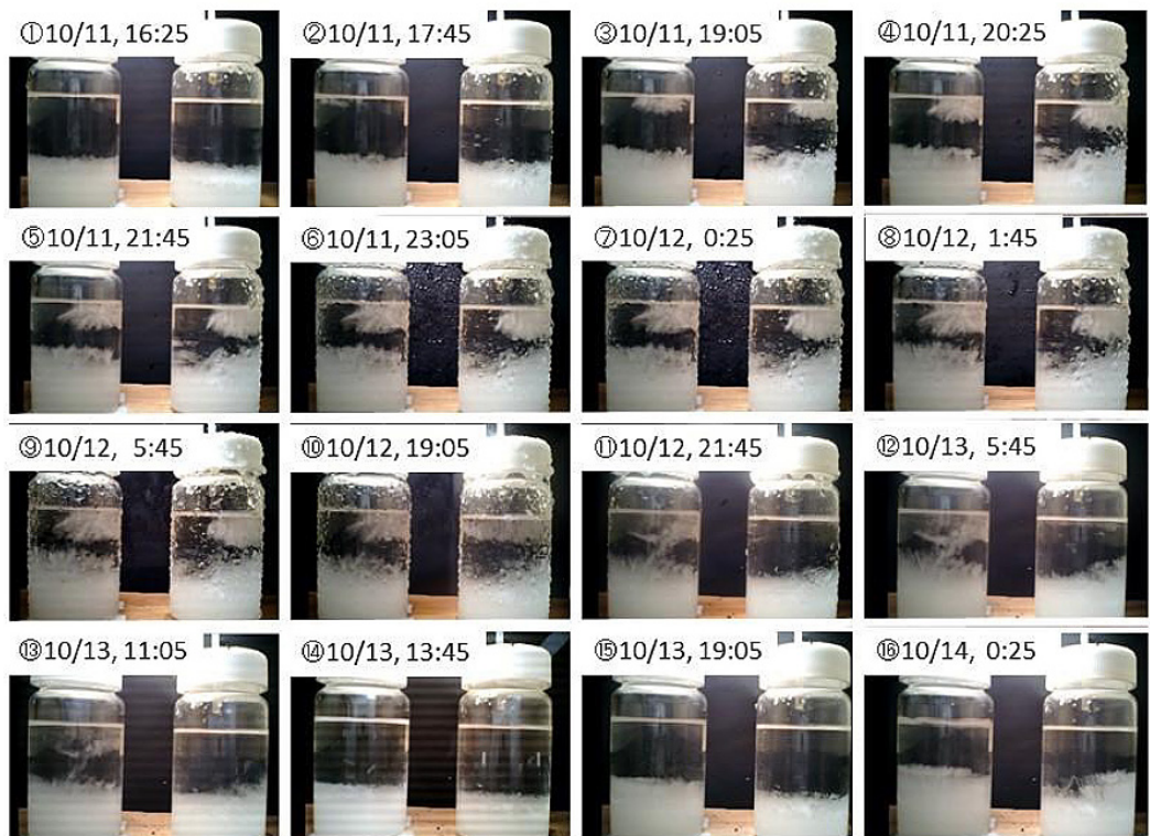
図5 台風19号通過前後におけるストームグラス内の変化
