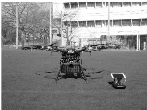
図2 音源搭載型ドローン
